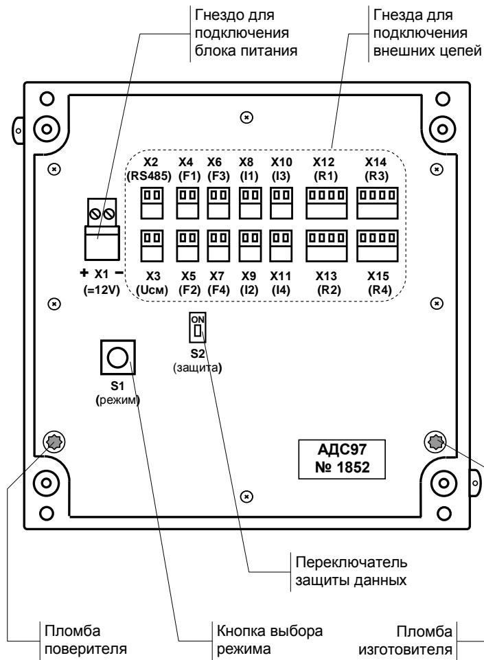
Рисунок 3.2 – Крышка. Вид на монтажную панель
