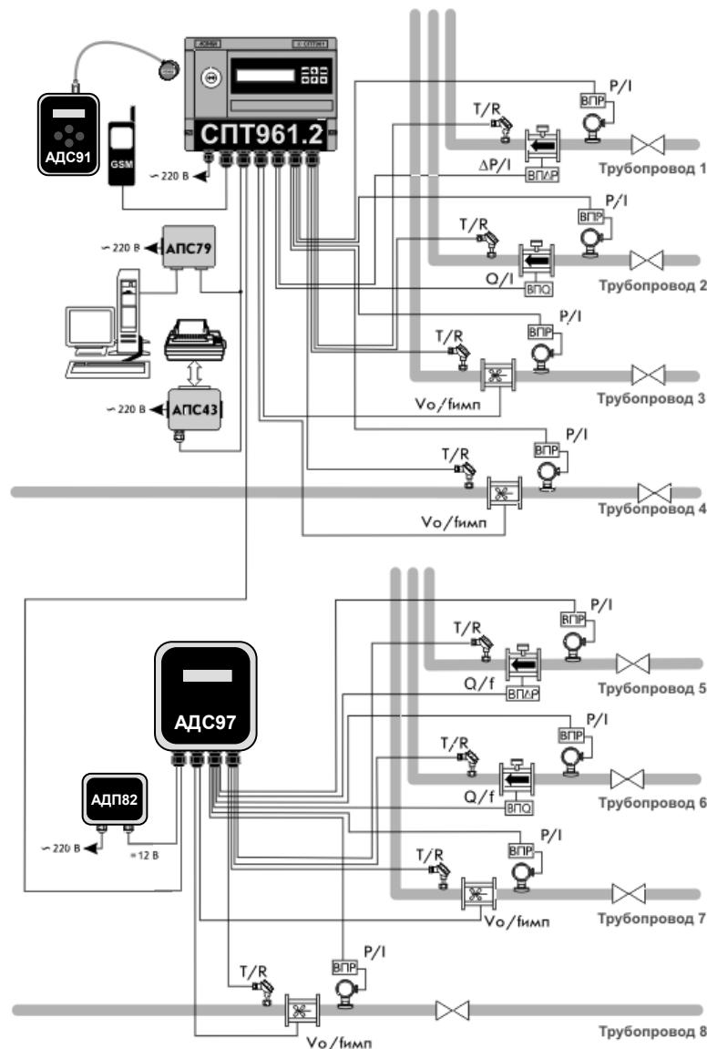
Рисунок 2.1 – Применение адаптера в составе измерительной системы
