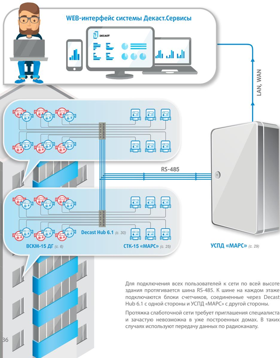
Для подключения всех пользователей к сети по всей высоте здания протягивается шина RS-485. К шине на каждом этаже подключаются блоки счетчиков, соединенные через Decast Hub 6.1 с одной стороны и УСПД «МАРС» с другой стороны.
