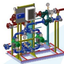
Модуль отопления Независимая схема с одним ТО и двумя насосами циркуляции отопления
