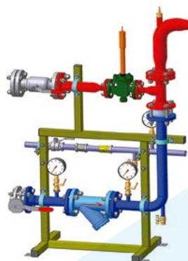
Модуль ГВС для открытой системы теплоснабжения с регулирующим клапаном прямого действия и линейной циркуляцией ГВС
