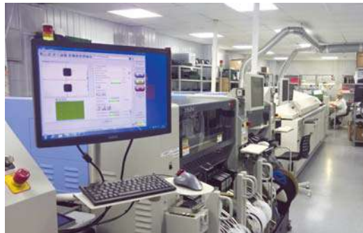
Линия поверхностного монтажа электронных компонентов
