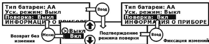
Рис. 3.13 – Включение режима проверки
