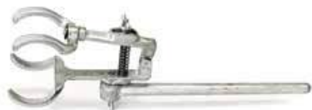
LA-120 Держатель четырехпальцевый (с узлом крепления)
