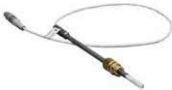
Термодатчик Pt-100 для аппарата ТВЗ-ЛАБ-01
